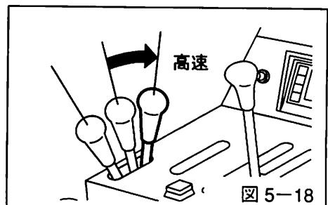
4. オーガコントロールレバーでオーガの高さを調整します。走行中、オーガケースの下端が地面に接触しないよう注意してください。
